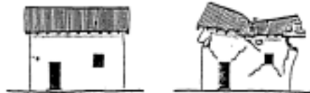
Colapso en una construcción de adobe con aberturas
