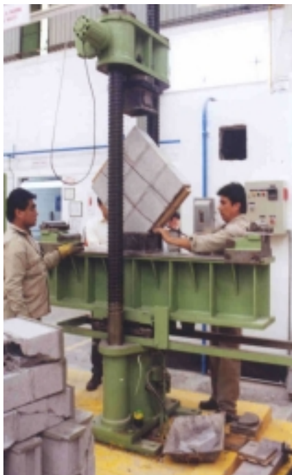
Figura 9.85 Ensayo de pilas de bloque de 140 mm
