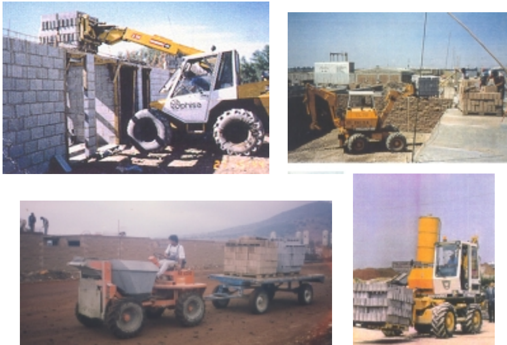
Figura 9.57 Manipulador telescópico y transporte
