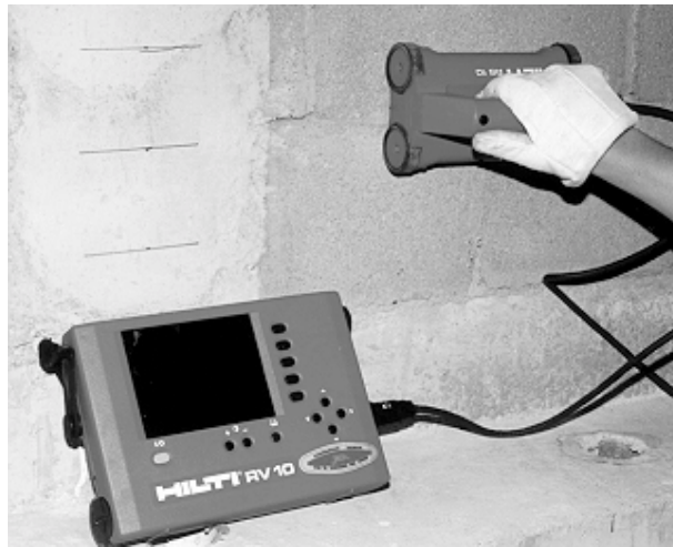
Figura 11.19 Moderno equipo para localizar barras de acero, y para determinar su diámetro y profundidad
