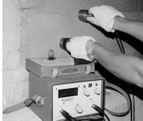
Figura 11.13 Equipo de transmisión de pulsos ultrasónicos
