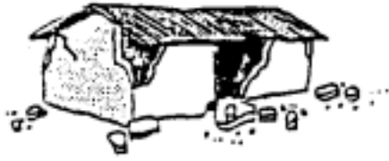
Falla en esquina y colapso de muros hacia afuera
